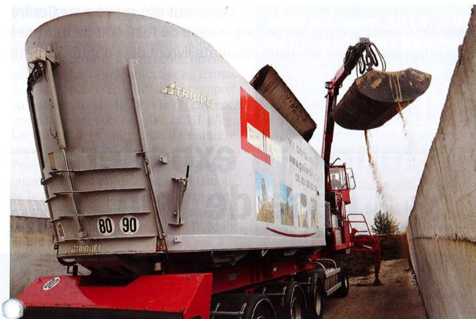
La mélangeuse autochargeuse conçue par Dominique Neige, de la société Pollen, est capable de mélanger des volumes conséquents, de l'ordre de 700 à 800 t par jour.
