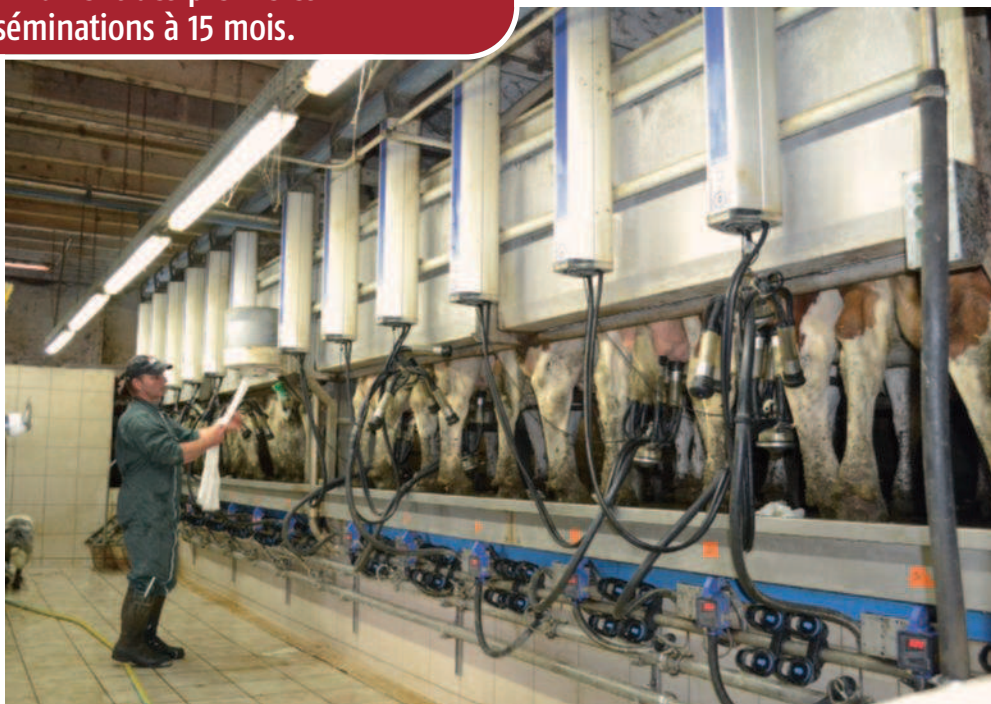
Elle ressemble à une salle de traite 1 x 12, mais il s'agit bien d'une 2 x 6 simple quai. TPA chez Delaval avec décrochage automatique et compteur à lait. Et la nécessité de séparer le troupeau dans deux aires d'attente. Au Gaec Le Chênet, en Haute-Savoie.
