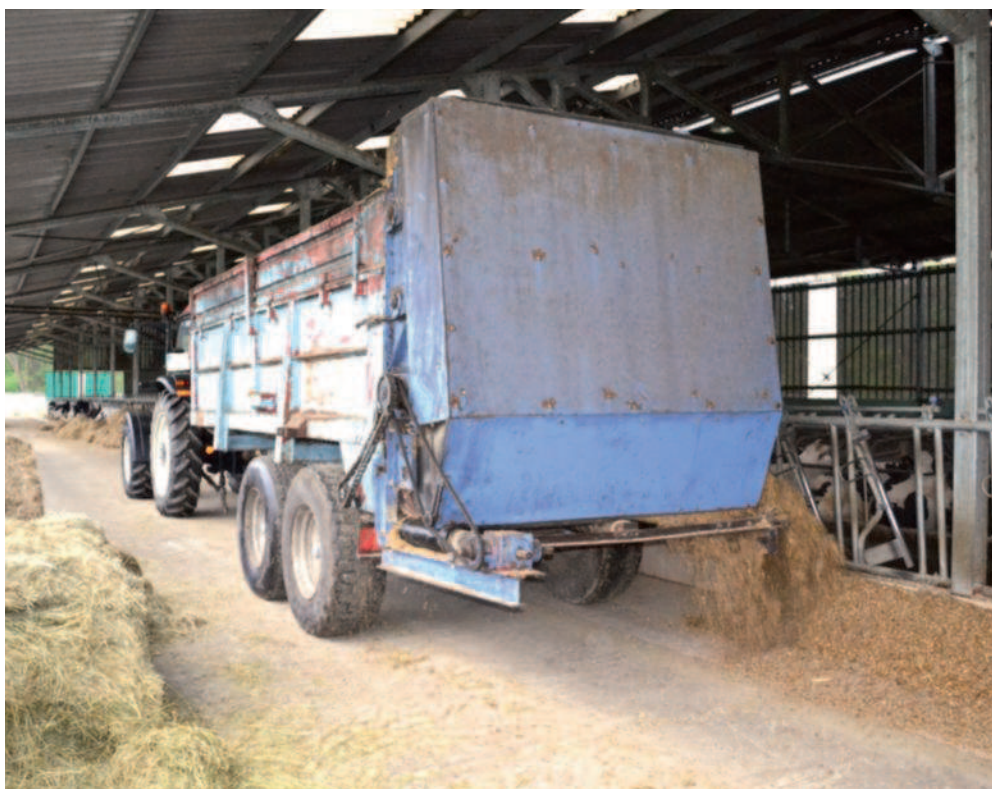
Un épandeur à trois hérissons a été modifié pour distribuer la ration à l'auge. Maïs et pré-mélange sont chargés au silo. Au Gaec Ferme Kleinfeld.
