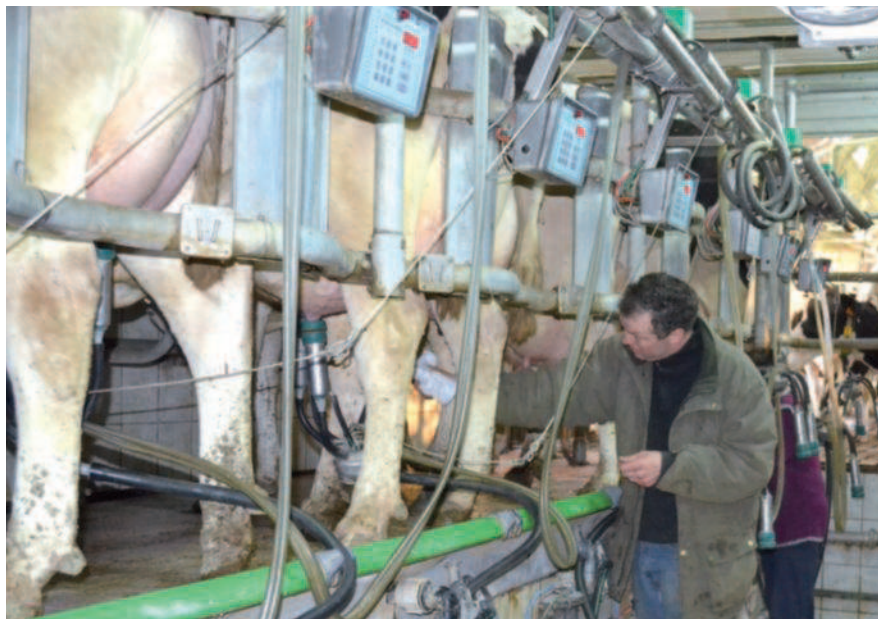
Une 2 x 9, traite arrière en épi. Chez GEA, avec décrochage automatique et compteur à lait. Avec aire d'attente entre les logettes. Au Gaec Ferme Kleinfeld, dans le Bas-Rhin
