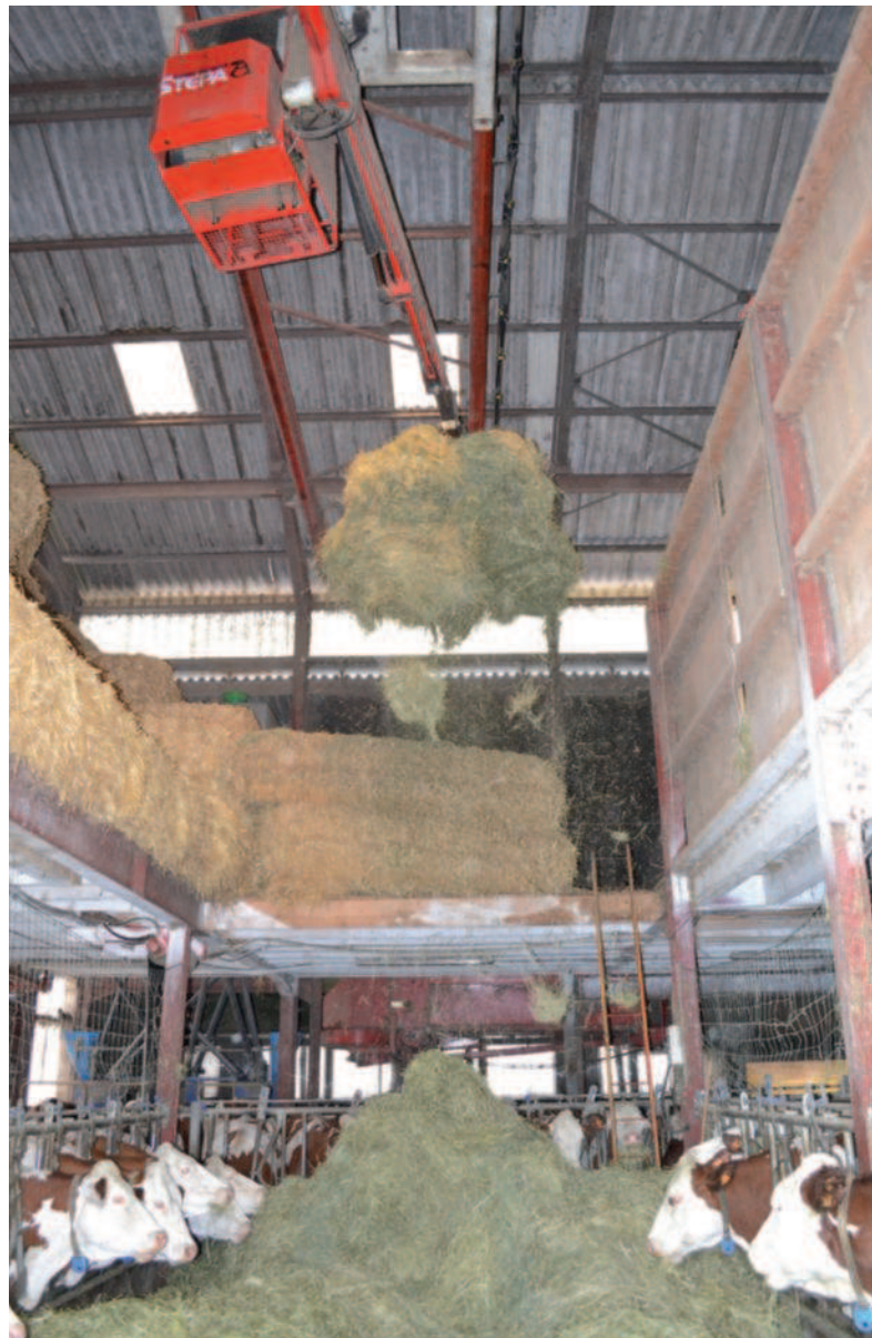
Le mélange de foin est réalisé avec une griffe et acheminé le long du cornadis sur un tapis roulant.
